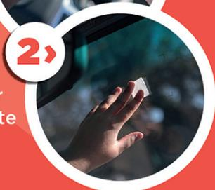
› Retira el papel que cubre el adhesivo del soporte. Instala el DISPOSITIVO de forma horizontal (como se muestra en la foto) en la parte superior central del parabrisas y mantenlo presionado durante un minuto.
